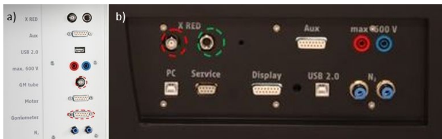
Slika 4.2. a) Priključci unutar komore rendgenske jedinice. b) Povezivanje MCA.
