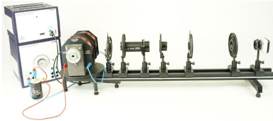
Slika 2.7. Eksperimentalna postavka za Zeemanov efekat.
