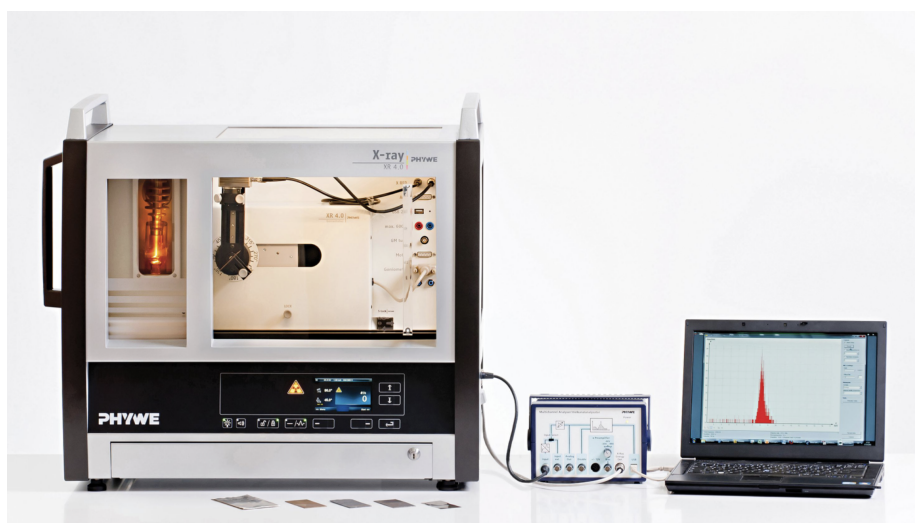
Slika 4.1. Izgled eksperimentalne postavke za kvantitativnu X-flourescentnu spektroskopiju metala.
