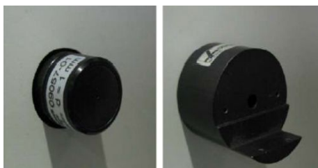
Slika 7.9. Postavljanje aperture i držača kristala.
