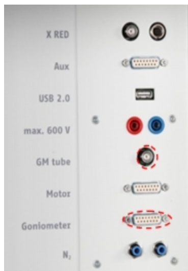
Slika 2.6. Ulazi za goniometar i Geiger-Müllerov brojač označeni su crvenim isprekidanim linijama.
