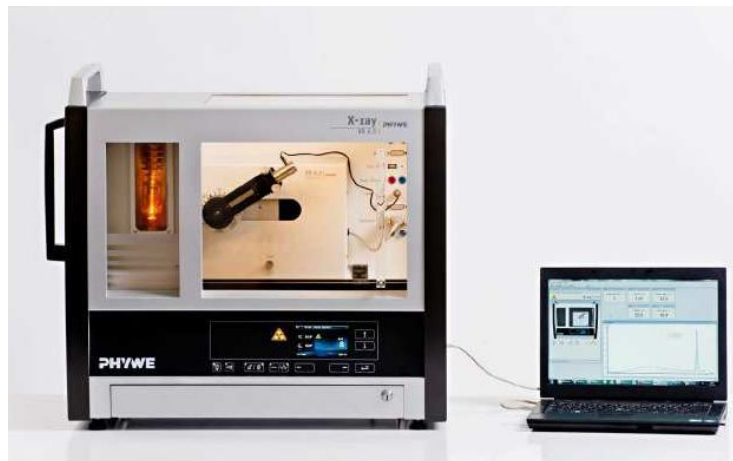
Slika 7.1. Eksperimentalna postavka za provjeru Duane-Huntovog zakona.
