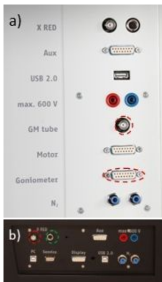
Slika 6.4. a) Ulazi u komori rendgenskog uređaja.b) Povezivanje MCA.
