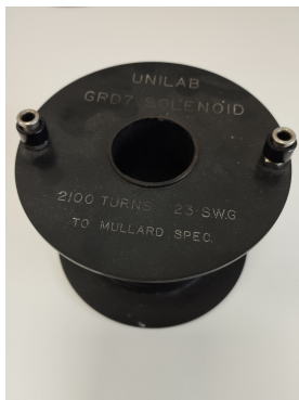
Slika 3.8. Zavojnica koja se postavlja oko diode.
