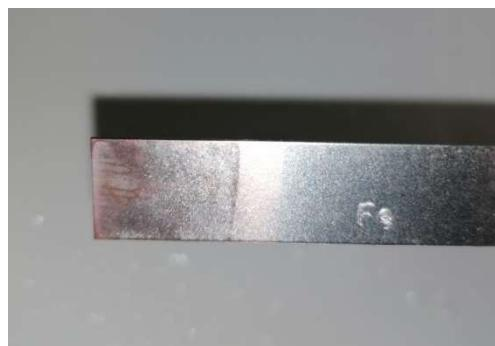
Slika 2.5: Tanki sloj bakra na uzorku željeza
