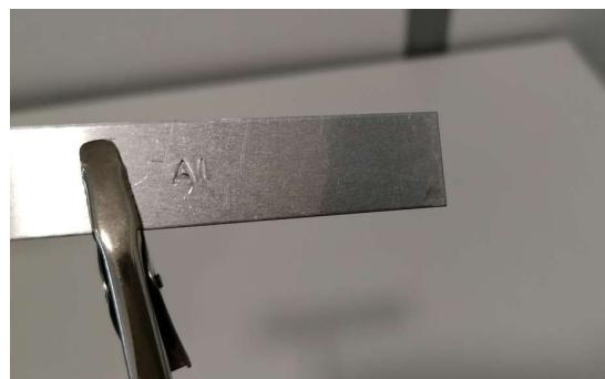
Slika 2.3: Eloksirani sloj na aluminiju
