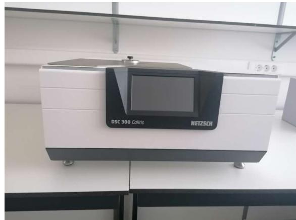
Slika 5.4: DSC uređaj NETZSCH 300 Caliris
